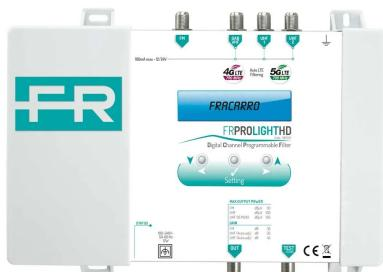
**Central programable** para filtrado altamente selectivo de canales de TV con **4 entradas** (FM, VHF+DAB, UHF, UHF) y nivel de salida de 108dB $\mu$ V para cada filtro. **15 filtros de 1 a 6 canales**, cada uno con 3 niveles de selectividad.
